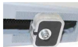
Tope mecánico en apertura
