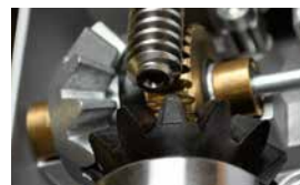
Engranajes de acero y bronce apoyados en rodamientos
