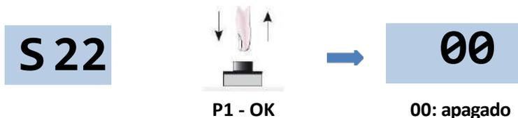
Mediante las teclas P2 (UP-arriba) y P3 (abajo) desplazar hasta visualizar en el display el valor "01" (encendido). Pulsar P1 para confirmar y regresar al grupo de selección S22.
