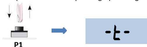
Mediante las teclas **P2** (UP-arriba) y **P3** (abajo) desplazar hasta visualizar en el display el menú configuración "S". Pulsar **P1** para confirmar y entrar en la configuración "S". En el display se visualizará S01.
