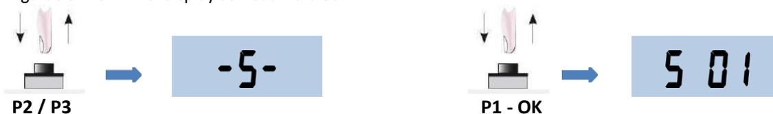
Mediante las teclas **P2** (UP-arriba) y **P3** (abajo) desplazar hasta visualizar en el display el grupo de regulación S16 (fotocélulas). Pulsar **P1** para confirmar y entrar así en el menú de activación/desactivación de las fotocélulas.
