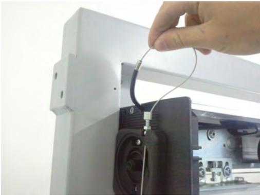
Introduzca el cable de acero dentro de la manilla de desbloqueo y de la vaina hasta que se alcance el bloqueo eléctrico.
