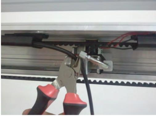
Introduzca la vaina usando las guías hasta que se alcance el bloqueo eléctrico.
