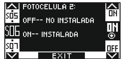
Seleccione ON si se ha instalado un sensor de seguridad en apertura en la entrada E.O.1.
