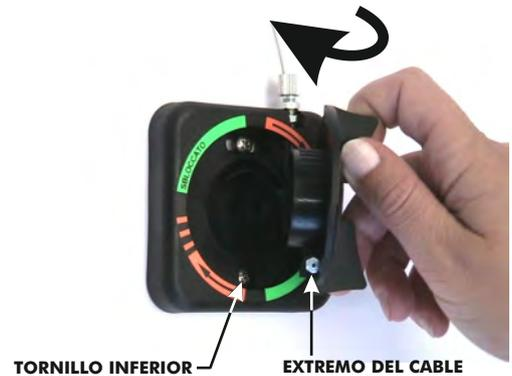
Ahora introduzca la manilla de desbloqueo en el fondo del mecanismo prestando atención a mantener el extremo del cable en el receptáculo del bloqueo del cable y la manilla en correcta posición. Al introducir la manilla el extremo del cable debe encontrarse en posición justo después, en sentido horario, del tornillo inferior de fijación.
