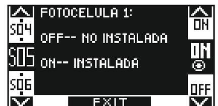
Seleccione ON si se ha instalado un sensor de seguridad en cierre en la entrada E.C.2.
