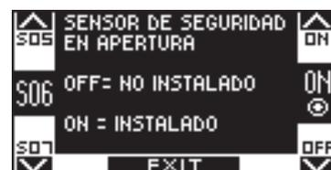
Solo si la función S05 se ha configurado en ON
