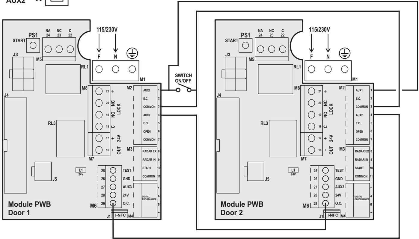
La figura ilustra el esquema de conexiones eléctricas entre las automatizaciones de las dos puertas para funcionar interbloqueadas.
