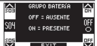
Seleccionar ON solo si se ha instalado un sensor de seguridad en cierre en la entrada E.C. (bornes 2 - 3).
