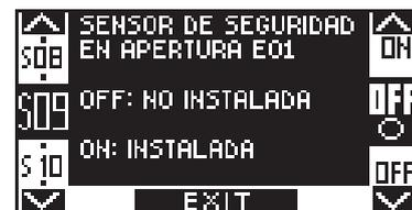
Seleccione ON si se ha instalado un sensor de seguridad en apertura en la entrada E.O.2.
