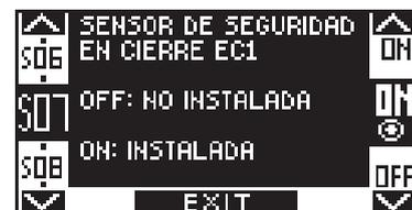
Seleccione ON si se ha instalado un sensor de seguridad en cierre en la entrada E.C.2.
